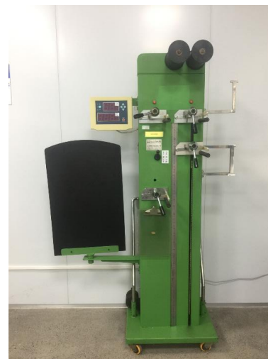
CETME 拉伸仪 CETME machine for the stretch testing
